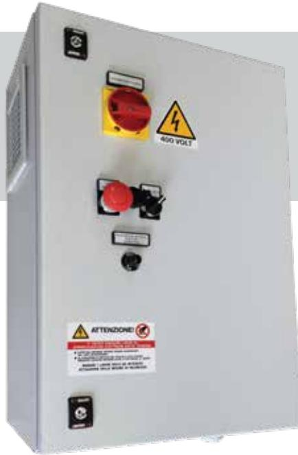
✓ Quadro IP54 con inverter a terra per il controllo di più ventilatori in modalità "manuale" o "automatica" mediante centralina climatica SENTINEL (posizionabile fino a 200mt. dal quadro) con sonde di temperatura ed anemometro. Questo sistema, se non posizionato correttamente, potrebbe creare anomalie di funzionamento su sistemi di comunicazione con antenne sprovviste della certificazione di compatibilità elettromagnetica.
